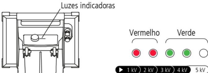
Na primeira conexão à bateria (com a chave seletora desligada), todas as luzes indicadoras de pulsos acendem-se por dois segundos. A seguir, se forem seleccionadas quaisquer outras posições da chave, as luzes indicadoras mostram a tensão de saída com cada pulso. Isso indica que o energizador está a operar normalmente.
