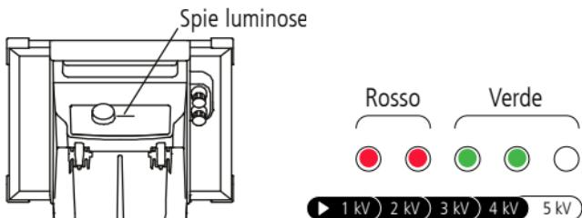
Durante il primo collegamento alla batteria (con il selettore impostato su spento), tutte le spie si illuminano per due secondi. Se in seguito vengono selezionate altre posizioni del selettore, le spie mostrano la tensione in uscita ad ogni impulso. Ciò indica che l'elettrificatore funziona correttamente.
