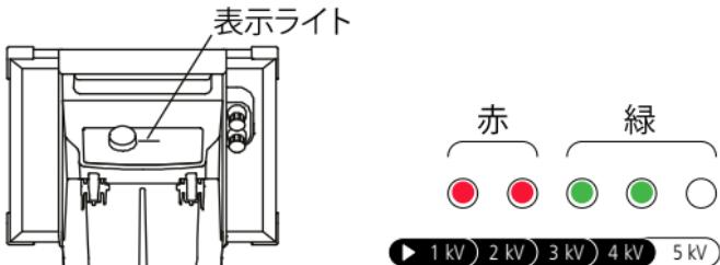
最初にバッテリーに接続したとき（切替スイッチはオフ設定）、すべての表示ライトが 2 秒間点灯します。その後、スイッチを切替えると、表示ライトは各パルスの出力電圧を示します。これは、電牧器が正常に動作していることを示します。
