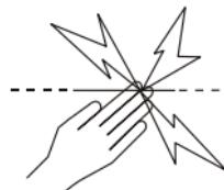
Asegúrese de que todo el equipo auxiliar alimentado por la corriente de la red y conectado al circuito de cercas eléctricas para animales disponga de un grado de aislamiento entre el circuito de cerca y el suministro de corriente de la red equivalente al grado de aislamiento que brinda el energizador.
