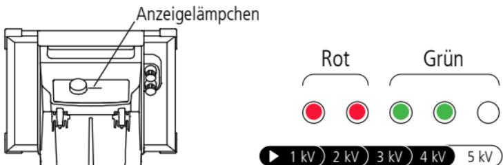
Beim ersten Anschließen des Weidezaungeräts an die Batterie (mit Wahlschalter auf „Aus“) leuchten zunächst alle Anzeigelämpchen zwei Sekunden lang auf. Wenn danach eine andere Schalterposition ausgewählt wird, zeigen die Anzeigelämpchen bei jedem Impuls die Ausgangsspannung an. Das bedeutet, dass das Weidezaungerät normal arbeitet.
