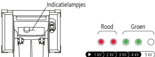
Wanneer het apparaat voor het eerst op de accu wordt aangesloten (en de Keuzeschakelaar is uitgeschakeld), gaan alle indicatielampjes gedurende twee seconden branden. Als vervolgens andere schakelstanden worden geselecteerd, geven de indicatielampjes de uitgangsspanning aan bij elke puls. Dat betekent dat het elektro-afrasteringsapparaat normaal functioneert.
