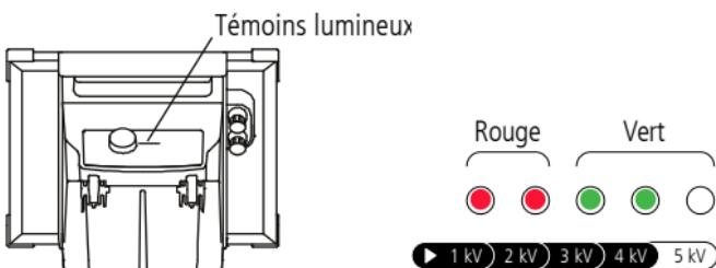
Lors du premier branchement de l'électrificateur à la batterie (le sélecteur étant placé sur désactivé), tous les témoins lumineux s'allument pendant deux secondes. Ensuite, lorsque d'autres positions du sélecteur sont sélectionnées, les témoins lumineux indiquent la tension de sortie à chaque impulsion. Ceci indique que l'électrificateur fonctionne normalement.
