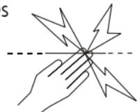
Achten Sie darauf, dass sämtliche netzbetriebene, an den Stromkreislauf des elektrischen Weidezauns angeschlossene Zusatzkomponenten zwischen dem Zaunstromkreis und dem Netzanschluss ebenso stark isoliert sind, wie das Weidezaungerät selbst.
