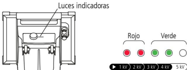
Cuando se conecten a la batería por primera vez (y el switch selector está en la posición de apagado), todas las luces indicadoras se iluminarán por dos segundos. Después, si se elige cualquier otra posición del switch selector, las luces indicadoras muestran el voltaje de salida de cada impulso. Esto indica que el energizador está funcionando normalmente.
