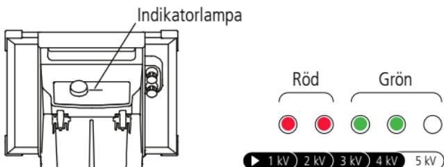
När det först ansluts till batteriet (och väljaromkopplaren är inställt på av) tänds alla indikatorlampor under en period av två sekunder. Därefter, om någon annan väljaromkopplarens positioner väljs, visar indikatorlamporna utspänningen vid varje puls. Detta indikerar att aggregatet fungerar normalt.
